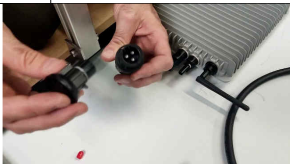
15. Inserte el tapón protector de la cascada del cable AC. Haga la presión adecuada para introducirlo.
